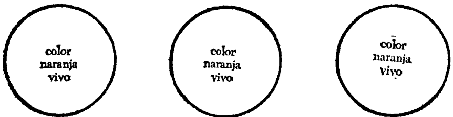
Fig. 5. Signo internacional especial para las obras e instalaciones que contienen fuerzas peligrosas.
